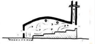
蛇窯，亦即龍窯，是一種細長、圓筒狀的窯，長度可達 100 公尺以上，大多蓋在山坡上，斜度大約為 15 度，利用其坡度而讓窯體上下兩處有高低落差，下方為燃燒口，上方接著高聳的煙囪，要燒的坯胎就擺在中間的窯身。
